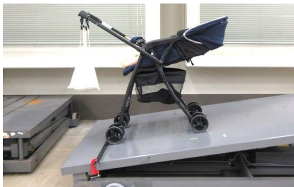
写真7. 登り方向の転倒角度の測定風景（対面の例）
