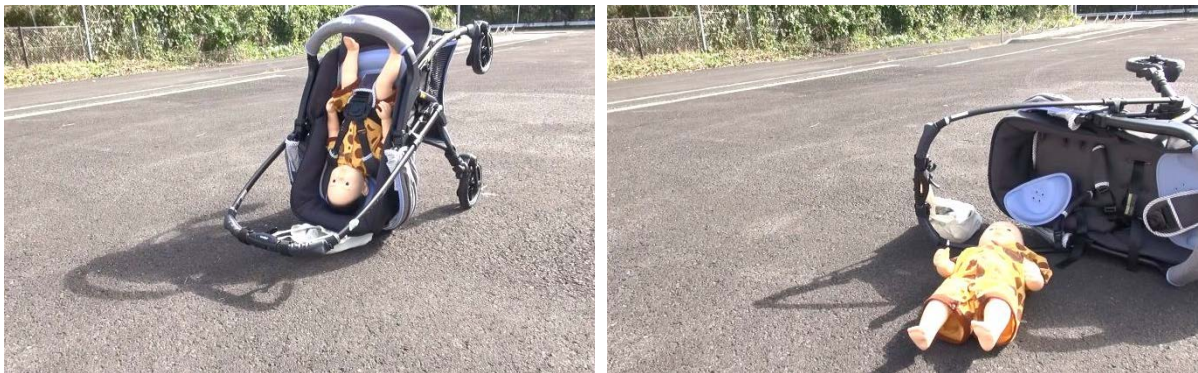
写真8. ベビーカー転倒時のシートベルトの影響（左：装着している、右：装着していない）
